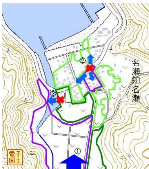
図 2-4. 知名瀬川周辺の浸水状況
